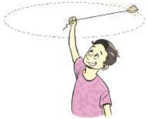
চিত্র ২.০৫: সুতায় বেঁধে একটি পাথর ঘোরানো হলে দ্রুতি এক থাকলেও বেগের পরিবর্তন হয়।
