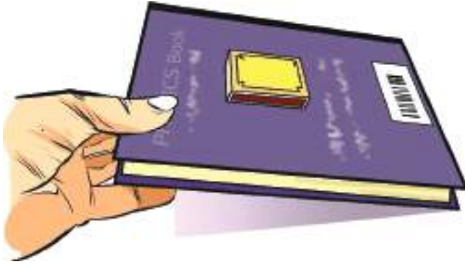
চিত্র 3.18: স্থিতি ঘর্ষণ সহগ পরিমাপ করা।
