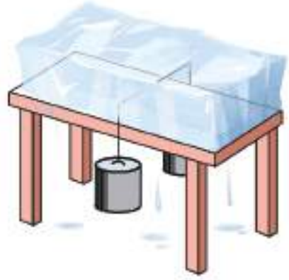
চিত্র ৬.০৯: একটি বরফ খণ্ডকে সূক্ষ্ম তারের চাপ দিয়ে কাটা সম্ভব।
