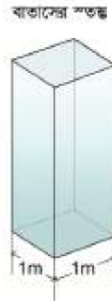
চিত্র ৫.০৬: বাতাসের চাপটি আসে বাতাসের স্তম্ভের ওজন থেকে।
