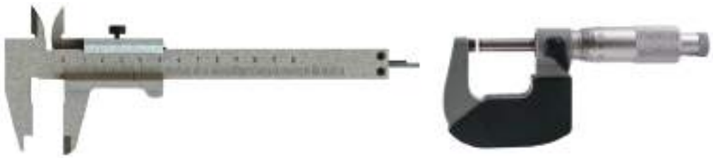
চিত্র ১.০৮: চিত্রটিতে ভার্নিয়ার স্কেলযুক্ত স্লাইড ক্যালিপার্স এবং একটি স্ক্রুগেইজ দেখানো হলো।
