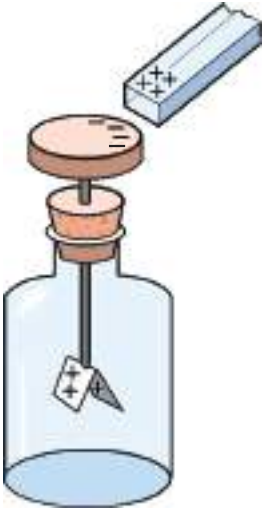
চিত্র ১০.০৮: ইলেকট্রোস্কোপে চার্জের উপস্থিতির কারণে সূক্ষ্ম ধাতব পাত পরস্পর থেকে সরে যায়।
